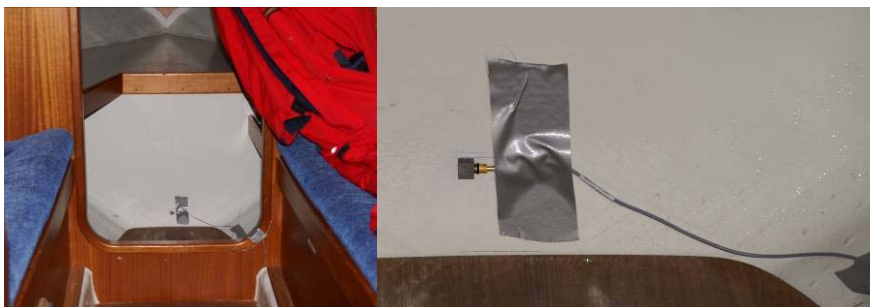
Figur 3. Den förliga accelerometern, Accelerometer 2, fastlimmad på förligaste tankskottet i ruffen.
